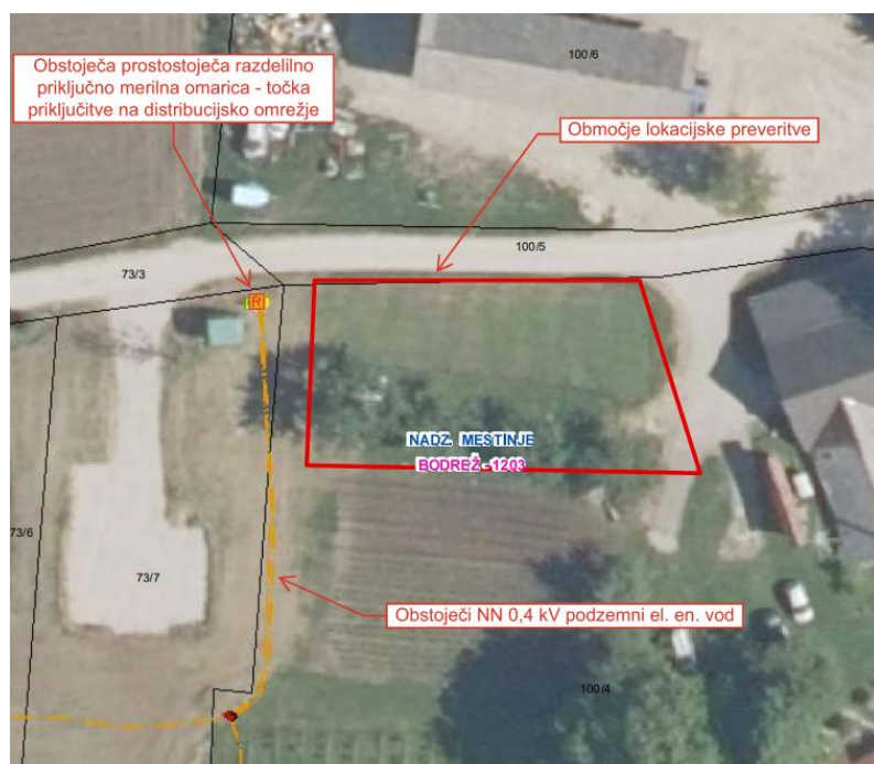
Slika 6: Prikaz priključitve na NN elektro omrežje; Vir: Elektro Celje d.d.
