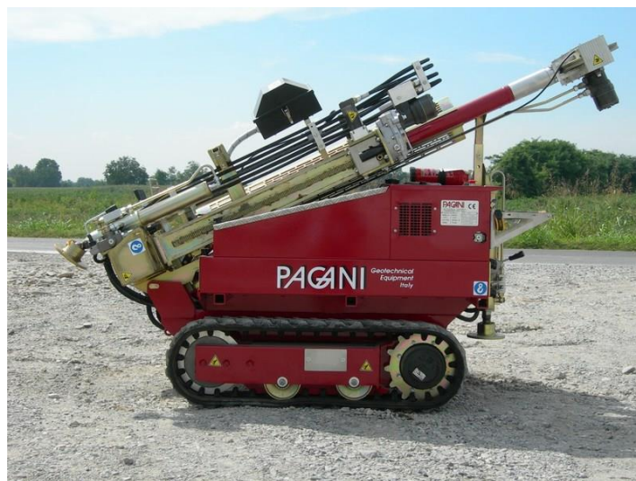
Slika 5: Dinamični penetrometer TG 63-100
